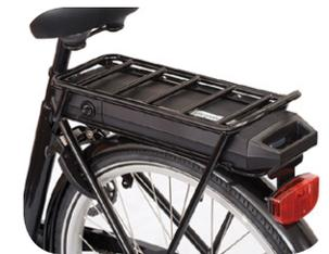
Zum abkoppeln des Akkus schließen Sie das Akkus Schloss auf indem Sie den Schlüssel rechtsum drehen. Anschließend ziehen Sie den Akkus mit Hilfe des Handgriffes aus der Controllerbox.
